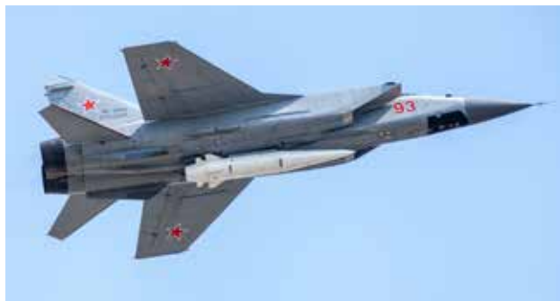
Avion d'interception russe Mikoyan MiG-31, équipé d'un missile ballistique hypersonique à lanceur aérien.
